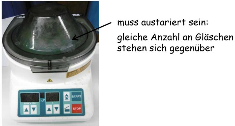
**Zentrifuge:** Trennung von feinpulverigen Feststoffen
