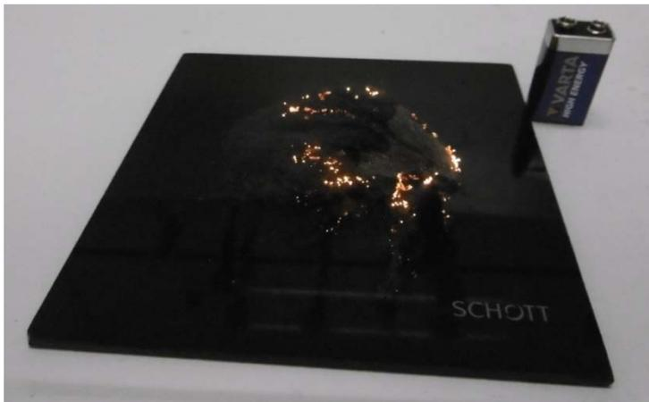
Eisenwolle wird mit einer 9V-Batterie angezündet
