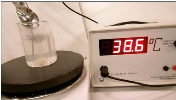
Durch Zugabe von Natronlauge erhöht sich die Temperatur auf  $38,6\text{ °C}$
