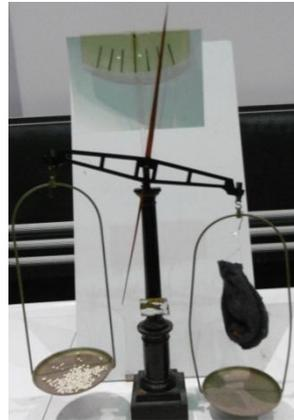
Eisenwolle wird angezündet und verbrennt zu Eisenoxid, das schwerer als elementares Eisen ist.
