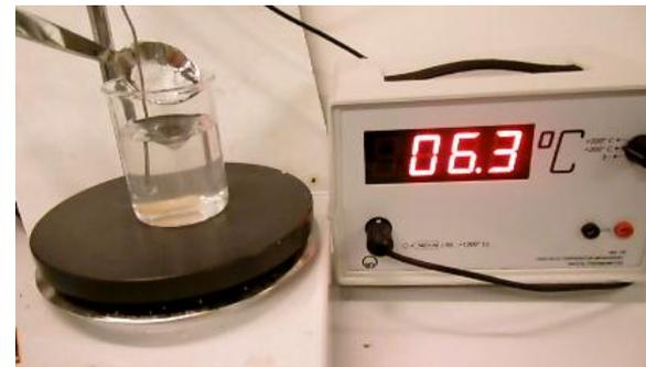
Durch Zugabe von Ammoniumnitrat sinkt die Temperatur auf  $6,3\text{ °C}$
