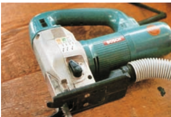
Bild 22: Abgesaugte Stichsäge zur Holzbearbeitung
