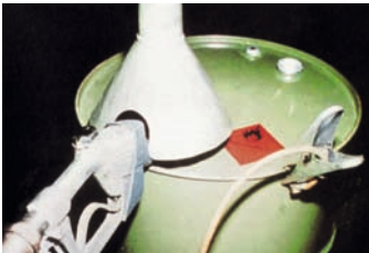
Bild 21: Absaugung an einer Fassabfüllung für gesundheitsgefährdende Flüssigkeiten
