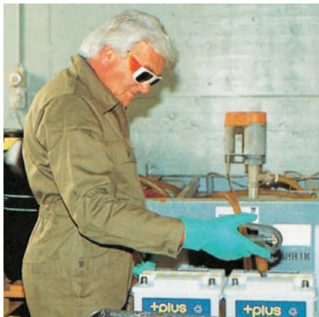
Bild 4: Befüllen von Batterien mit Schwefelsäure
