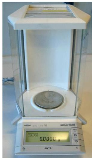
Waagen müssen stets sauber gehalten und schonend behandelt werden. Zunächst wird ein Wägegefäß auf die Waage gestellt (niemals Substanzen direkt auf die Waage geben!), dann wird „Tara“ gedrückt, um das Gefäß nicht mitzuwiegen. Nach dem Trieren wird die zu wiegende Substanz abgewogen. Als Wägegefäß für Feststoffe dient ein Uhrglas,
