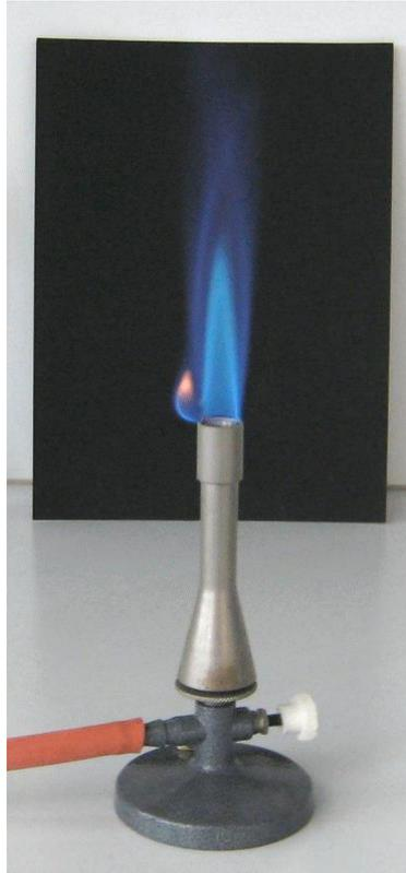
Ist die Luftzufuhr zu groß oder der Gasdruck zu klein, so schlägt der Brenner durch, das heißt, das Gas brennt im Innern des Brennröhres an der Gasaustrittsdüse. In diesem Fall muss die Gaszufuhr sofort abgestellt werden. Nach dem Erkalten des Brenners stellt man dann die Luftzufuhr etwas kleiner oder vergrößert die Gaszufuhr.
