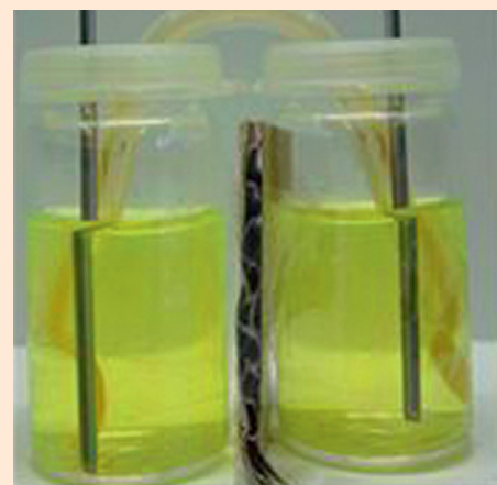
Abb.6: Aufbau der PBB-2-Topf-Zelle
