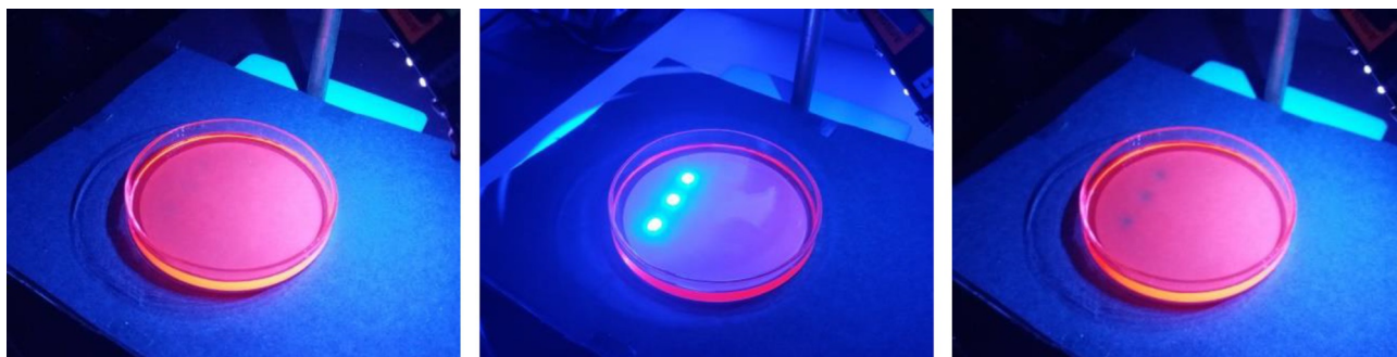
Abb. 11: INHIBIT-Schaltung mit dem System (SP/MC/MCH + ) im Lösemittel Ethylenglykol (V9) [12]
