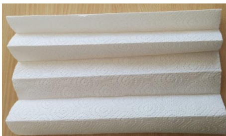
Abbildung 2. Das Zewa wird gefaltet, sodass 2.5 cm breite Lagen entstehen (links), jeweils ein Gummi wird über die Enden gelegt (rechts).
