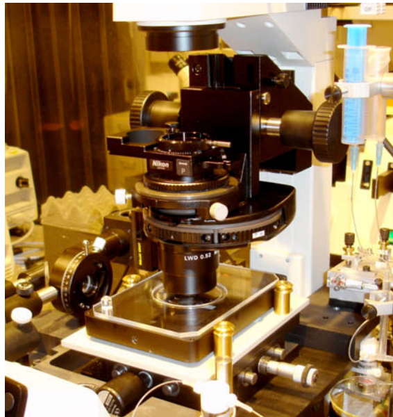
Abbildung 4.13.: Fotografie der DIC-Durchlichtoptik des inversen Mikroskops mit dem sich darunter befindenden Inkubationssystem.
