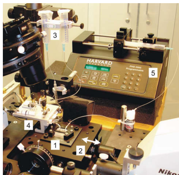
Abbildung 4.10.: Fotografie des Probenstischaufbaus und des Mikro-Flusssystems für Prisma-TIRFM-Experimente. Probenpositionierung: (1) Halterung der Flusskammer, unter der sich das Objektiv befindet; (2) auf dem Mikroskoptisch befestigter Kreuztisch mit Apertur, der in der eingezeichneten Dimension motorisiert bewegt werden kann. Mikro-Flusssystem: (3) Zwei Probenreservoirs, zwischen denen während einer Messung gewechselt werden kann; (4) Teil des Mikro-Ventilsystems direkt an der Flusskammer; (5) programmierbare Spritzenpumpe zur Kontrolle der Flussrate und Steuerung der Ventile.
